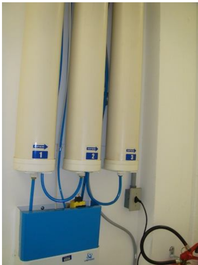
Figura 4: Fotografia de um sistema desenvolvido no DQ-USP, constituído de colunas de troca iônica: Os números 1, 2 e 3 gravados nas colunas representam, respectivamente carvão ativado, resinas catiônicas e resinas aniônicas.
