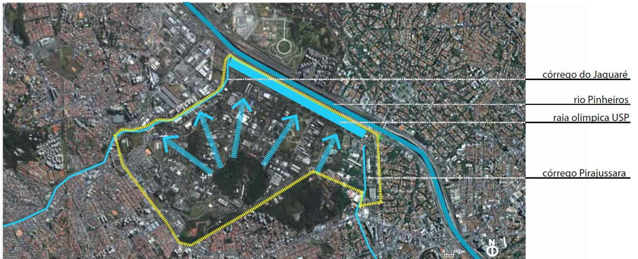
Figura 02. Campus CUASO- sentido das águas de chuva na área-situação atual e sobrecarga do sistema de drenagem da cidade.
