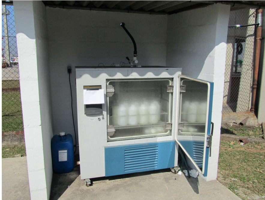
Figura 1–Coletor automático de águas pluviais..
