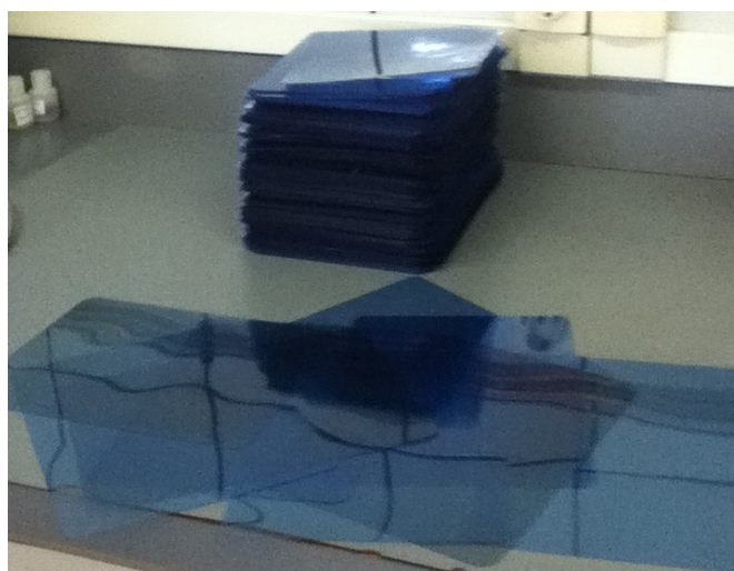
Figura 7 - Chapas de raios-X após tratamento químico e em condições de sofrer reciclagem.
