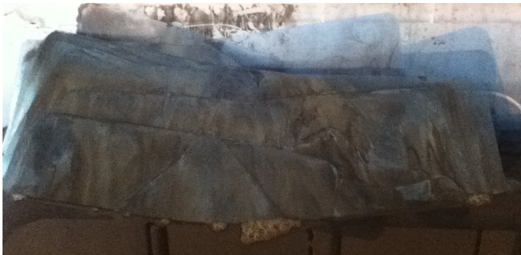
Figura 4 - Chapas de raios-X mergulhadas em solução de hidróxido de sódio.
